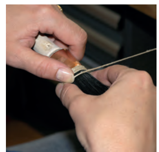
Montage de cordage sur pinceau de pouce
