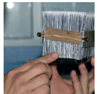
Collage de la garniture de soie avec le corps de la brosse
