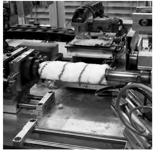
Thermofusion des rouleaux à peinture professionnels
